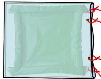
Dritter Bac über die OTTER-Green ziehen und mit zwei Blitzbindern schliessen. Dabei werden die Blitzbinder durch das Bac-Material gestossen.
