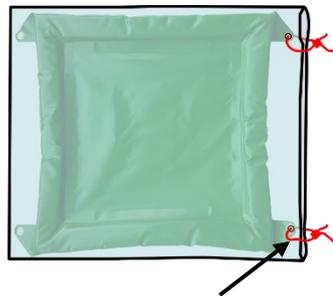
Beide Bac mit Blitzbindern an den Ösen der OTTER-Green befestigen.
