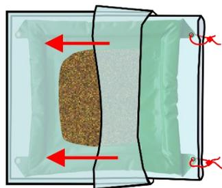
Die Blitzbinder der obersten Bac entfernen, danach den offenen Rand zurückziehen, so dass die aufgefangene Flüssigkeit in den Bac gelangt.
